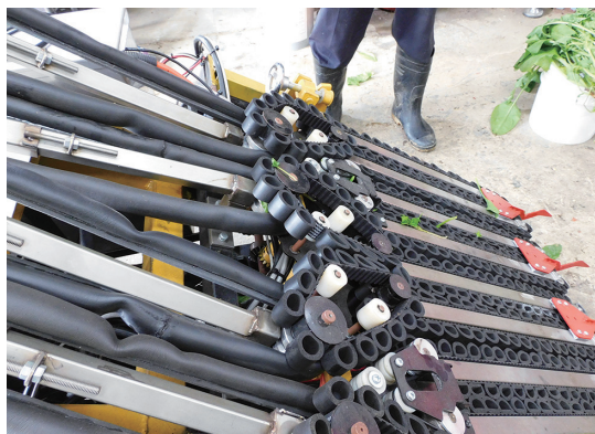
改良型設施葉菜整序型收穫機雛型機
