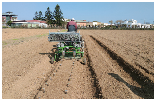
移植機構雛型進行移植測試
