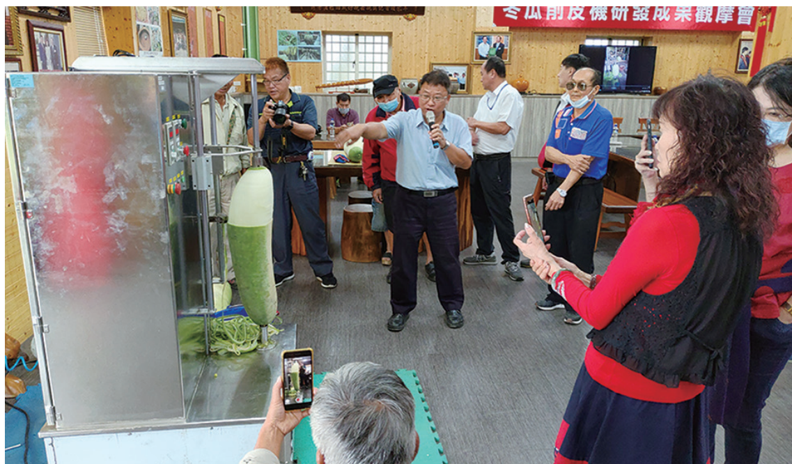
冬瓜削皮機研發成果觀摩會及冬瓜機械削皮情形
