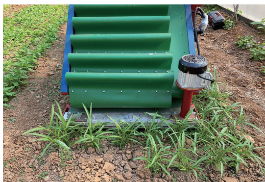
無線遙控電動葉菜散裝收穫機測試
