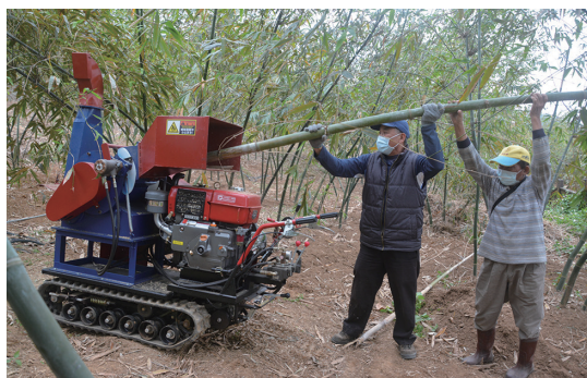
履帶式植物殘枝粉碎機粉碎測試
