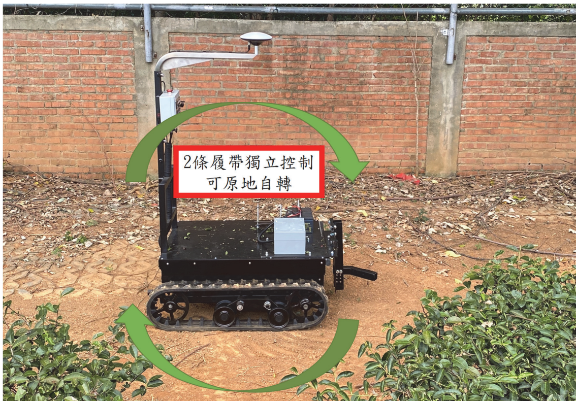
圖 6、電動履帶車原地自轉
