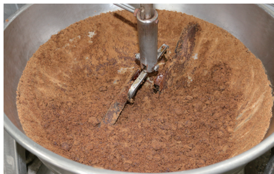
▲圖4. 以蒸氣二重釜攪拌機半自動化製作黑糖。
