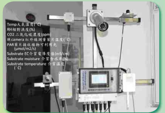
↑農業用無線通訊感測系統，可同時量測8項環境、作物及土壤參數(左側白字部分)。
