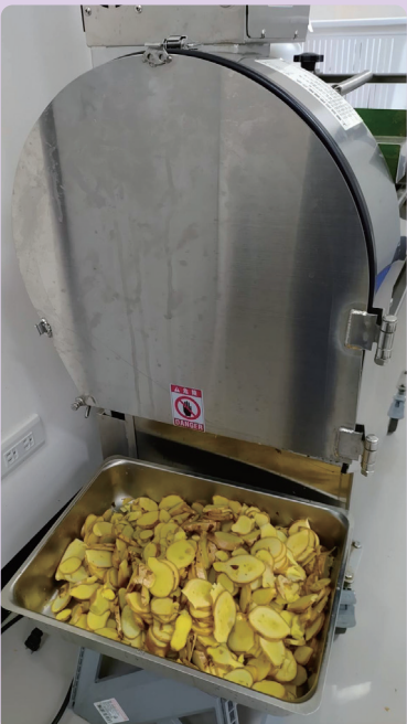
▲將切片機導入生產製程可提高薑切片效率。
