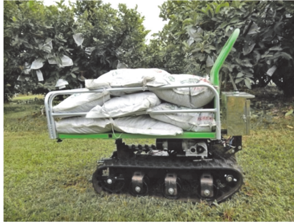
圖 6、高雄區農業改良場開發之履帶式電動智能跟隨農地搬運機
