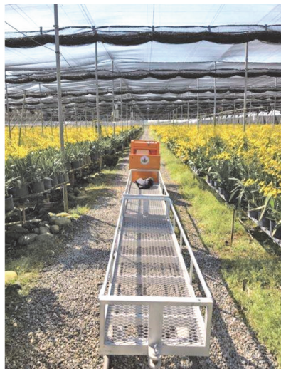
圖 7、台中區農業改良場開發之文心蘭電動自走式省工搬運裝置
