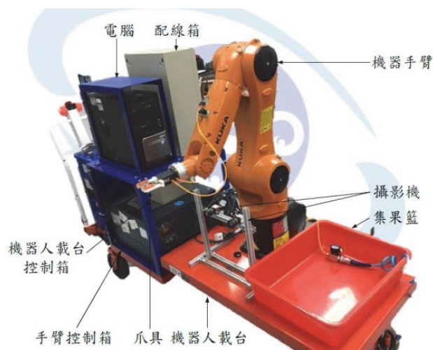
圖 4、宜蘭大學開發之設施內甜椒採收機器人系統
