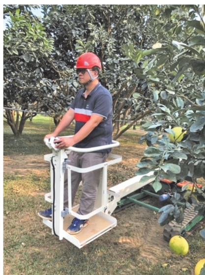
圖 5、臺南區農業改良場開發之電動履帶新型高空作業車
