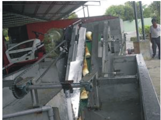
圖7.自動供筍機構竹筍輸送作業情形
