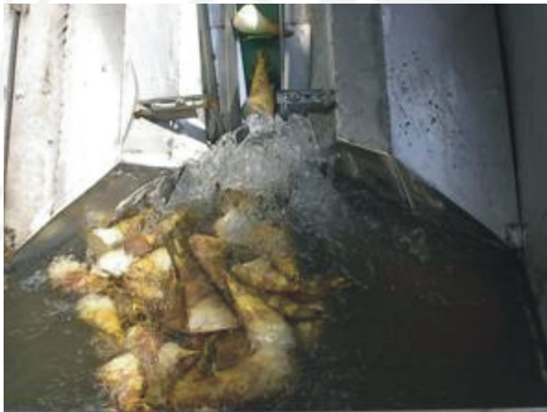
圖6.供筍機構作業情形
