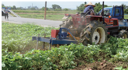
▲ 圖2. 曳引機附掛甘藷去藤一貫收穫機作業情形。
