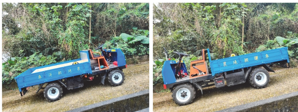
圖 6、電動農用搬運車其坡地煞車停駐測試現場圖照
