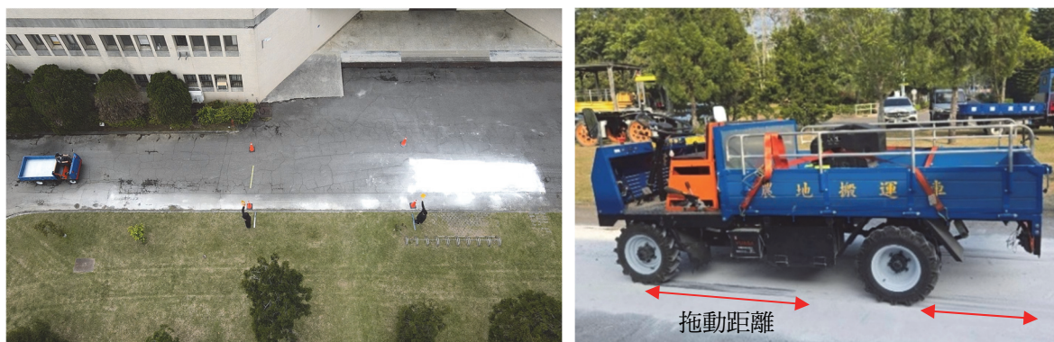
圖 5、電動農用搬運車其拖動距離測試現場圖照
