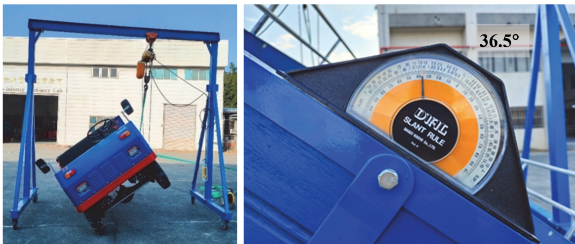
圖 4、電動農用搬運車在空車靜態時進行側面翻覆角測定
