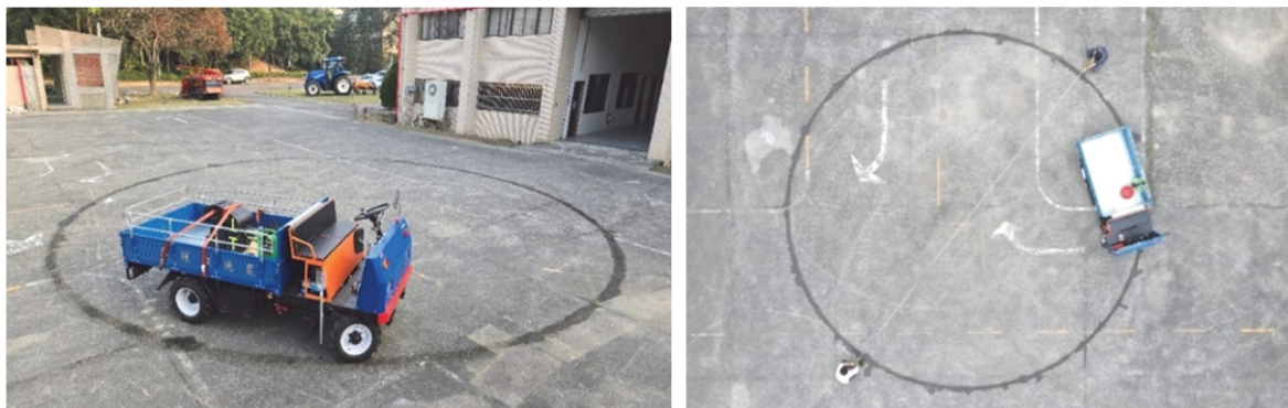
圖 3、利用滴水壓印法量測電動搬運車轉彎繞行的軌跡及量測
