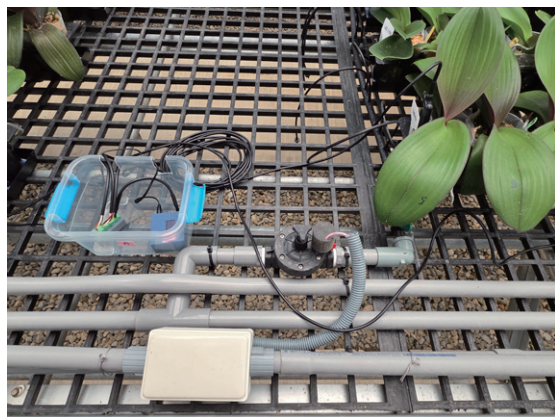
▲ 圖 2. 栽培床設置物聯網土壤濕度計及電磁閥等設備。
