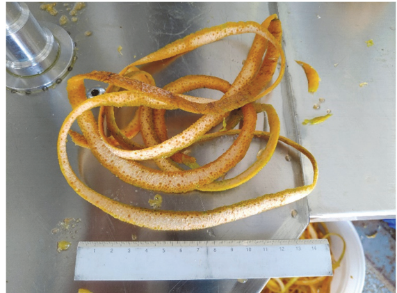
圖 3、使用本機削下的桶柑外果皮情形
