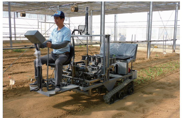
▲ 圖 3. 本場育成基地內履帶式電動葉菜移植機測試情形。
