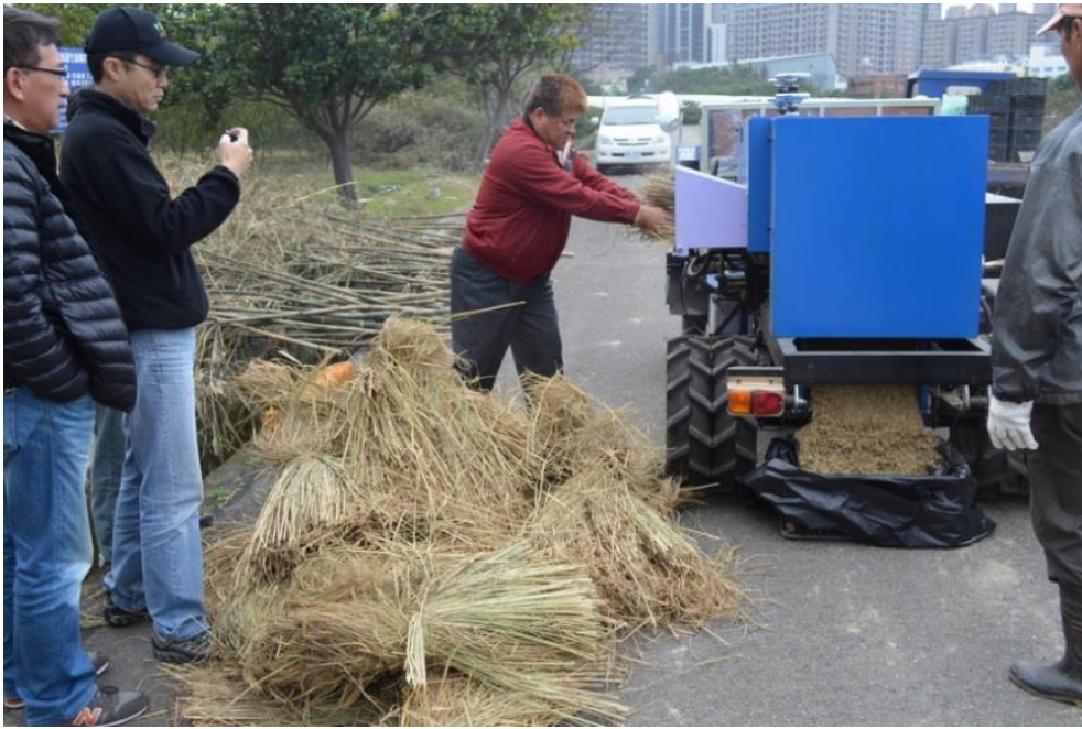
圖 3. 植物殘枝粉碎機粉碎稻桿操作情形
