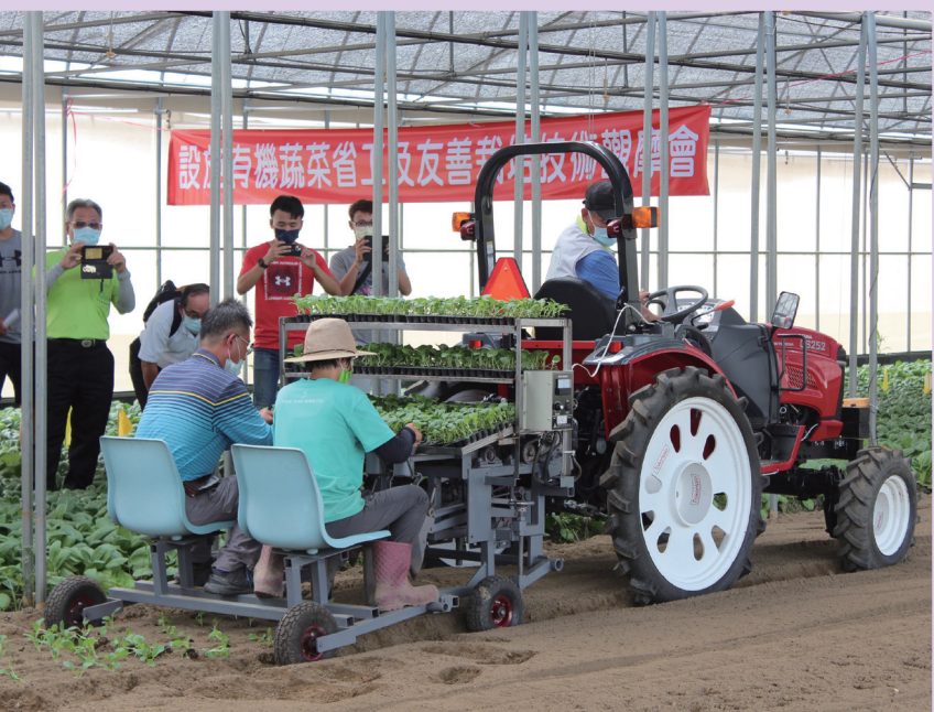
▲可變行株距葉菜移植機田間操作技術套組（右），相較人工移植（左），具有省工、高效、成功率高等效益。
