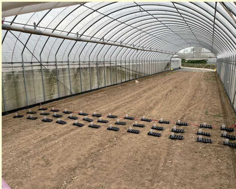
▲溫室內塑膠杯擺放方式,於噴頭下方及噴頭間每隔一定距離放置。
