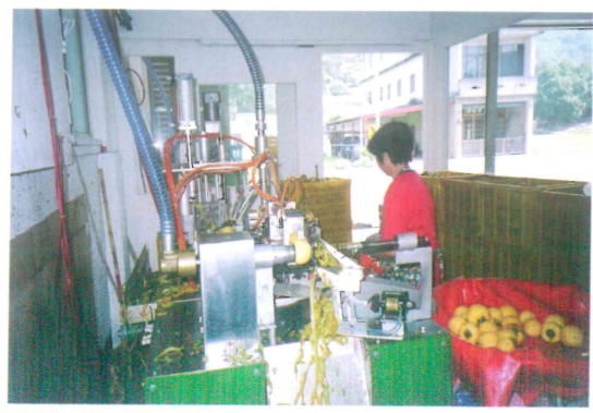
橫向吸附固定削皮作業情形
