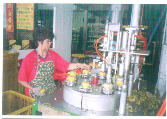
柿子加工削梗修蒂與削皮機進料定位作業情形
