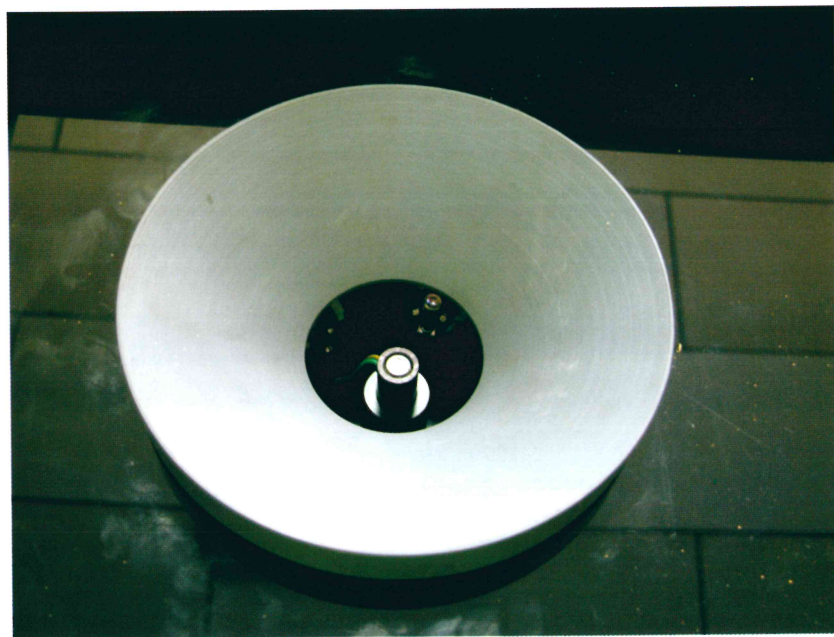
圖 4. 水果糖度測定儀之圓型水果座
