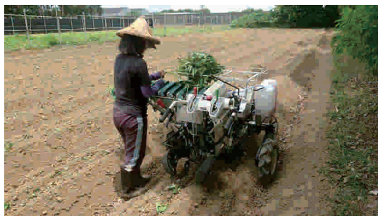
圖2. 甘藷插植機田間操作情形。
