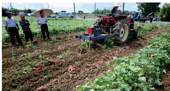
圖3. 曳引機附掛甘藷去藤收穫一貫作業機田間操作情形。
