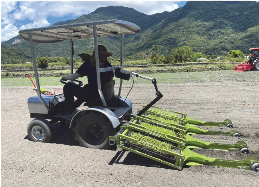
圖 1、研發之紙穴盤電動移植機
