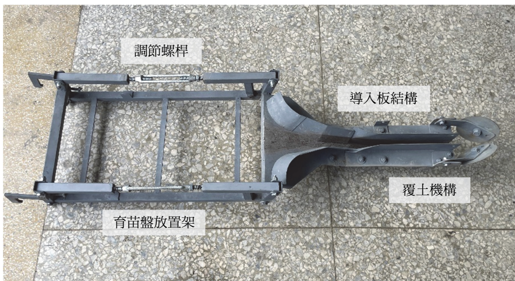
圖 2、開發之紙穴盤移植機構
