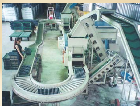
▲循環式穴盤自動化育苗播種系統
