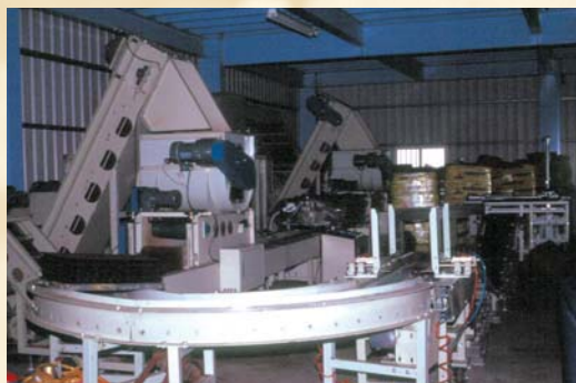
▲具有排、積盤機之自動化育苗播種系統
