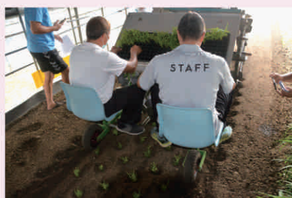
▲可變行株距蔬菜移植機操作情形，完成一列三行移植。
