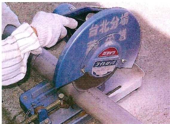
圖9. 將塑膠管每隔5-6公分鋸約3公分長條孔，做為通氣之用
