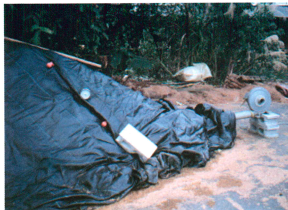
圖 11. 堆肥表面覆蓋雜草抑制蓆，3 吋塑膠管外接 1/2HP 送風機
