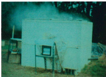
圖 8. 堆肥箱送氣發酵過程
