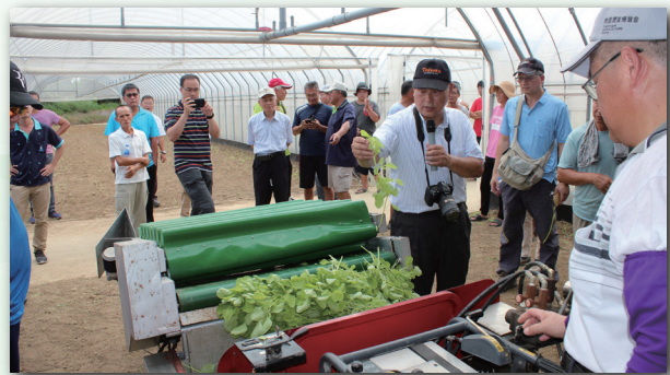
▲本場所研發的電動葉菜散裝收穫機，由邱副研究員銀珍說明可用於莧菜及葉菜甘藷收穫，不會造成葉片受損而影響葉菜品質。
