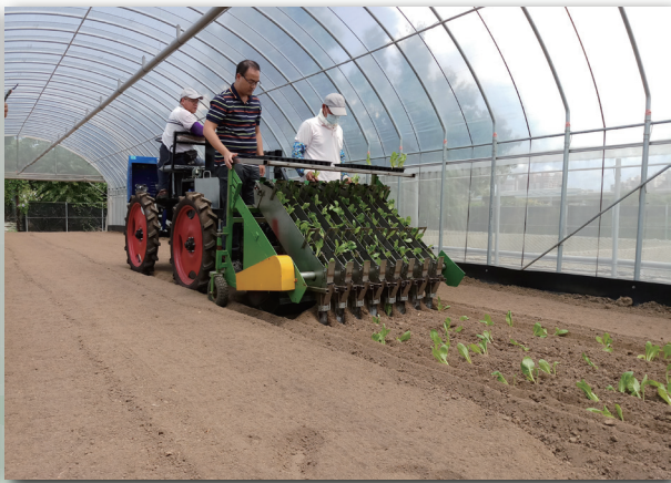
▲本場所研發的小葉菜移植機，需要3位人力操作，苗的定植不需要彎腰進行，可站立在後方進行補苗。(由本場黃助理研究員柏昇(左1)、謝富英先生(右1)，詹德財先生(駕駛)示範操作)
