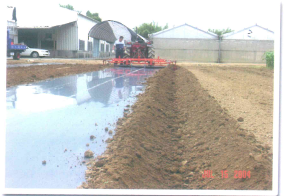
塑膠布覆蓋機畦溝覆土情形
