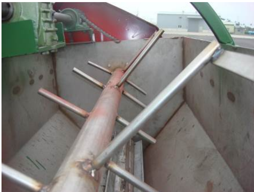
圖 3. 施肥器肥料箱內之攪拌軸
