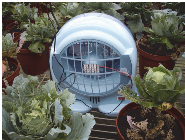
圖 1. 改裝市售捕蚊燈田間害蟲誘殺試驗情形
