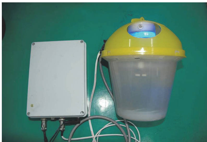
圖 2. LED 誘蟲器雛形機外觀
