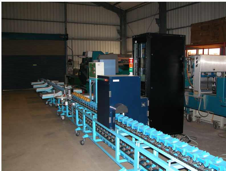
圖 1. 光電水果品質檢測系統全貌
