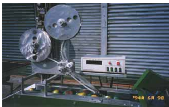
圖 5. 蔬果用自動貼標籤機作業情形
