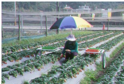
圖 4. E 型草莓採摘乘坐車田間使用情形
