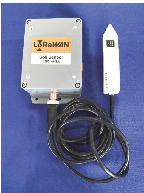
圖 3. 三合一無線土壤感測器（含水率、溫度、電導度）
