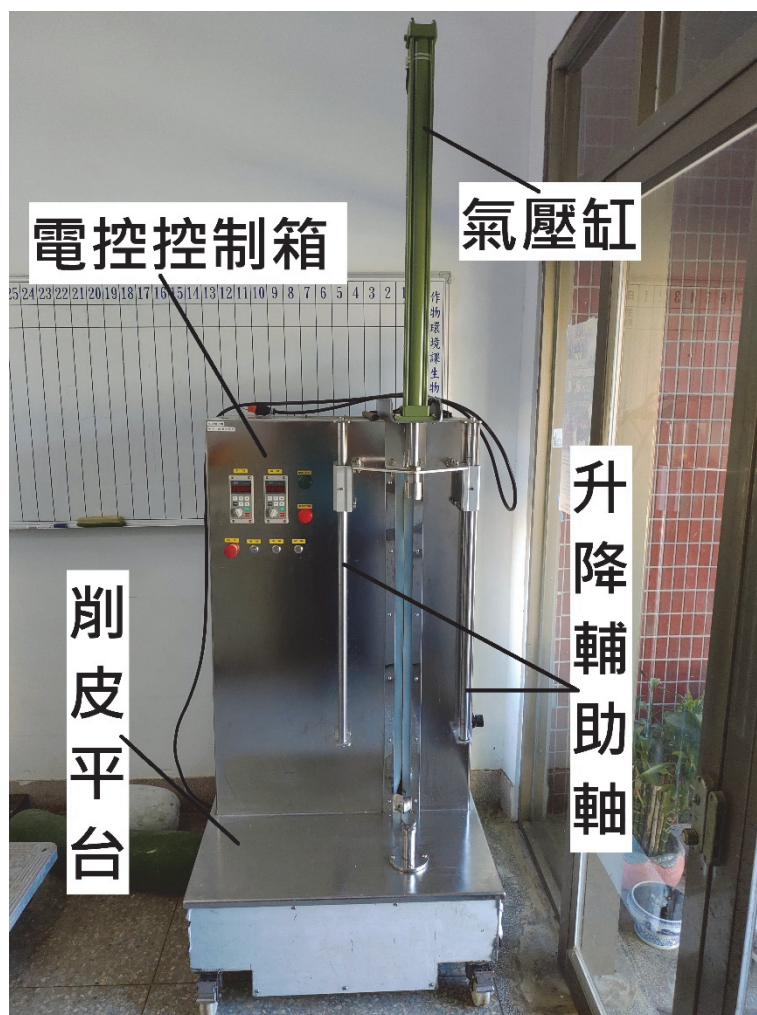
圖 3. 本研究所研發之冬瓜削皮機
